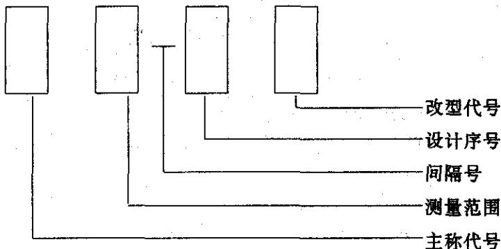
2.1.2 产品型号由主称代号、测量范围、间隔号、设计序号和改型代号组成(测量范围与改型代号只在必要时给定)。
